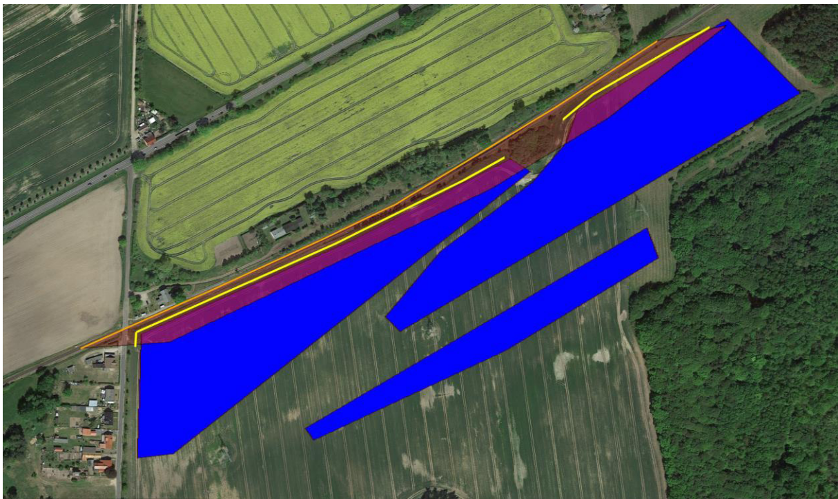
Abbildung 25: Empfohlener Blendschutz entlang der Bahntrasse in Gelb, von potenzieller Blendung betroffenes Sichtfeld in Rot, betroffener Streckenabschnitt in Orange
