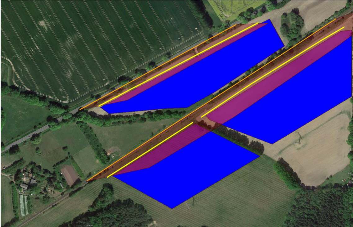
Abbildung 26: Empfohlener Blendschutz entlang der Bahntrasse und Bundesstraße (1) in Gelb, von potenzieller Blendung betroffenes Sichtfeld in Rot, betroffener Streckenabschnitt in Orange
