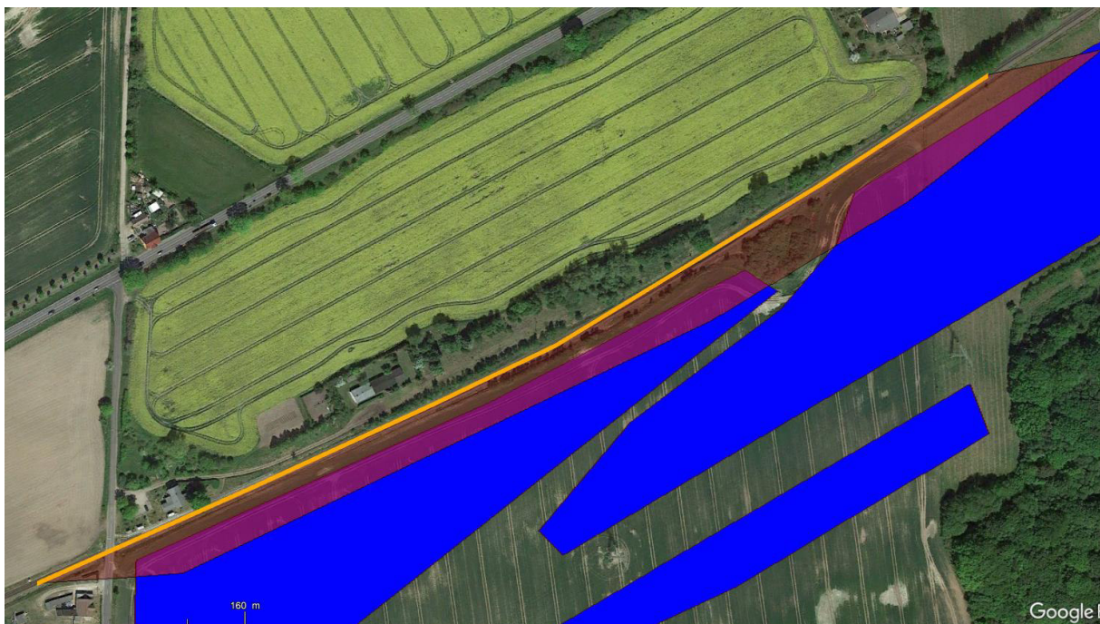
Abbildung 14: Von potenzieller Blendung betroffenes Sichtfeld entlang der Bahntrasse Abschnitt 1 in Rot, betroffener Streckenabschnitt in Orange
