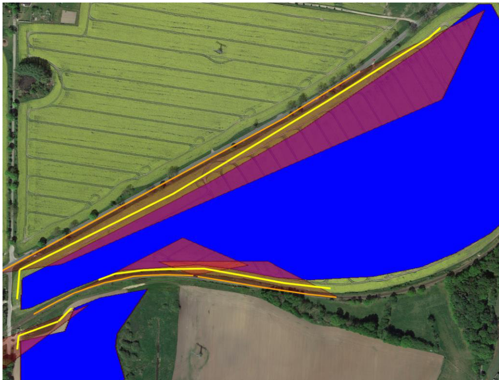
Abbildung 27: Empfohlener Blendschutz für Bahntrasse und Bundesstraße (2) in Gelb, von potenzieller Blendung betroffenes Sichtfeld in Rot, betroffener Streckenabschnitt in Orange
