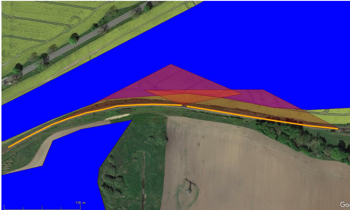
Abbildung 17: Von potenzieller Blendung betroffenes Sichtfeld entlang der Bahntrasse Abschnitt 2 (2) in Rot, betroffener Streckenabschnitt in Orange
